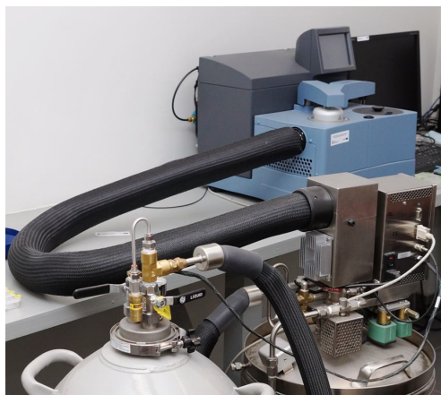
Różnicowy kalorymetr skaningowy DSC Q2000 firmy TA Instruments z układem chłodzenia ciekłym azotem
